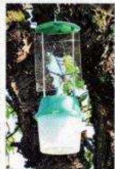
Mit Luftelektoren werden die in Baumkronen fliegenden Insekten erfasst.
